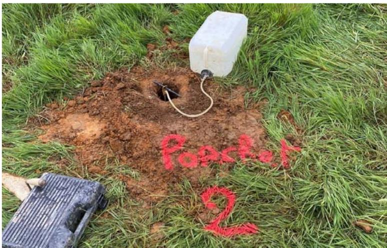
Mesure de perméabilité
