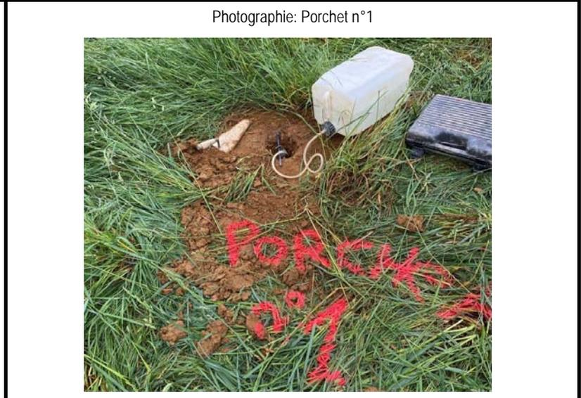
Mesure de perméabilité
