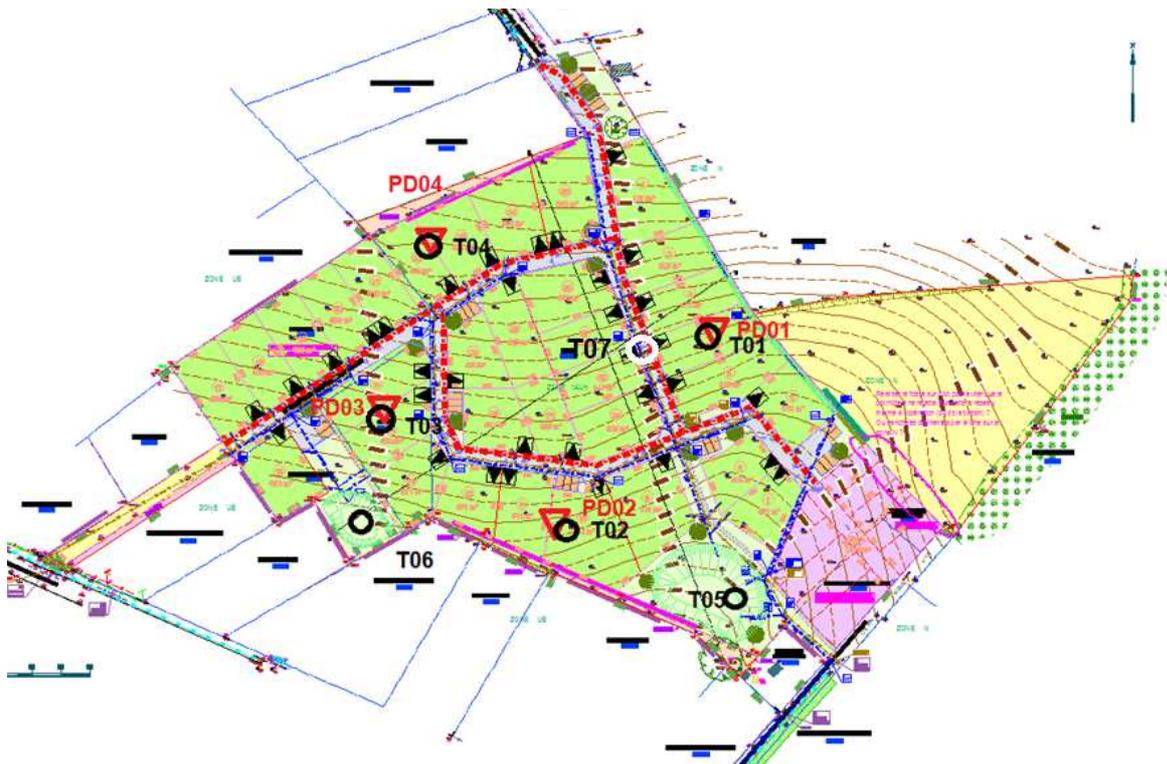
Les sondages ont été creusés à la tarière mécanique ( $\phi$  63 et 150 mm). Ces sondages ont mis en évidence la coupe géologique suivante :
