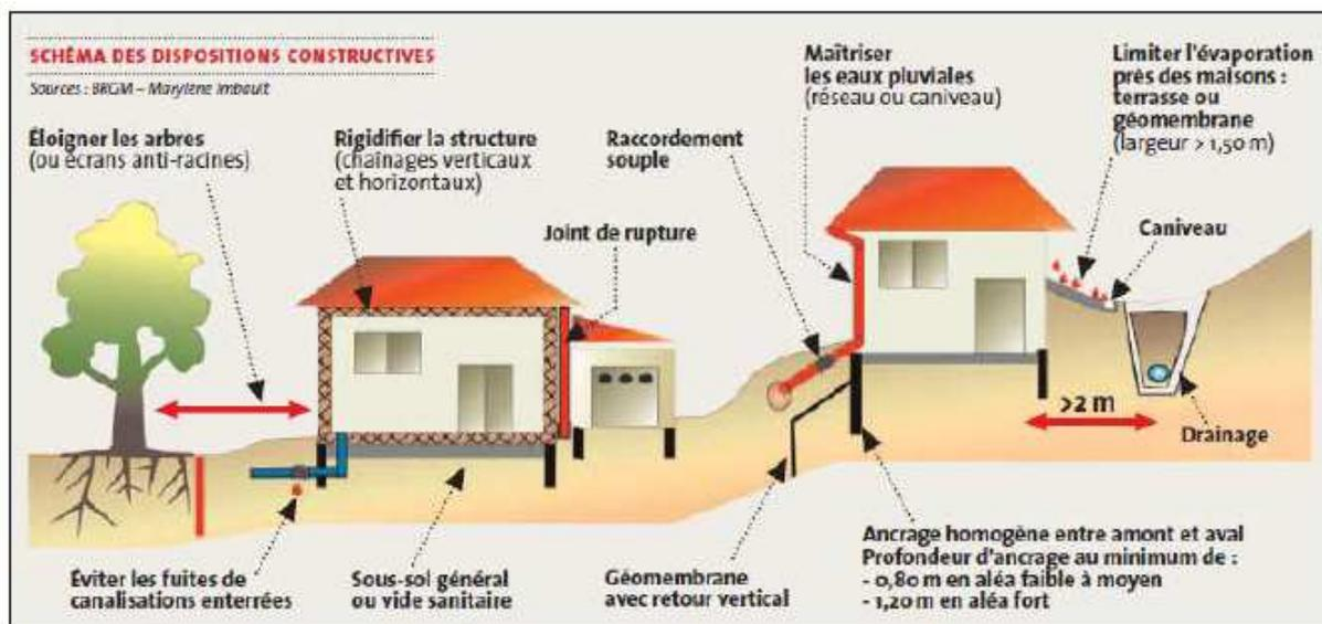
Illustration 6 : Schéma synthétique des dispositions constructives (www.georisques.gouv.fr)
