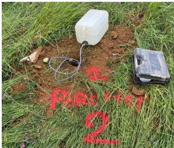
Mesure de perméabilité
