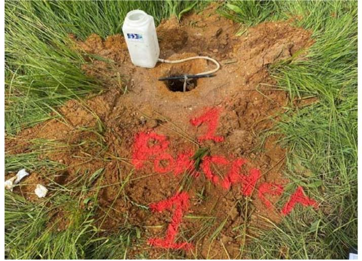
Mesure de perméabilité
